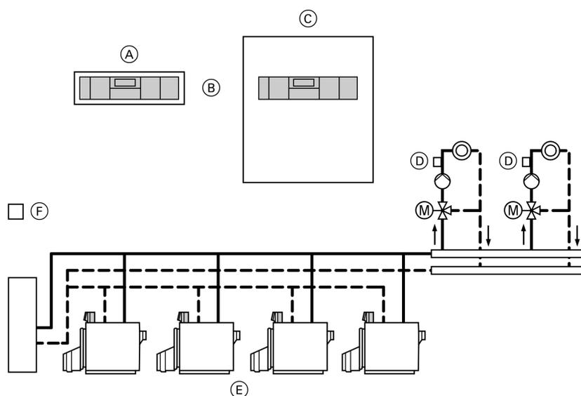
(A) Vitotronic 333 (тип MW1)
